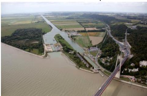
A droite, l'ancienne écluse datant de 1890 et mesurant 238 m de long pour 16 m de large ; la nouvelle, à gauche, a été construite plus tard, en 1974. Elle mesure 203 m de long et 24 m de large. ©HAROPA PORT
